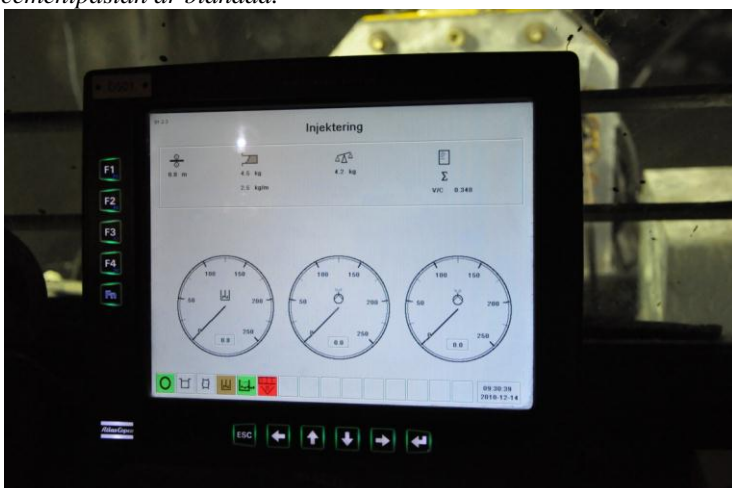
Bild 16. Kirunagruvan. Där fokuserades undersökning på automatiserad bultsättning. Display som visar hur cementpastan är blandad.
